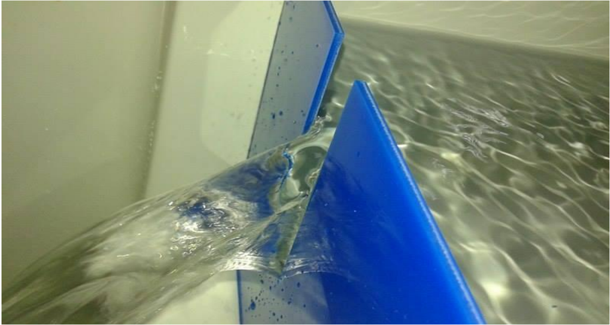
Figure III. 14: Vue de l'écoulement à l'amont et à l'aval du dispositif. Ecoulement de droite à gauche.
