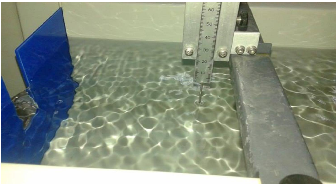
Figure III. 11: photo du limnimètre et du déversoir mises en expérience.
